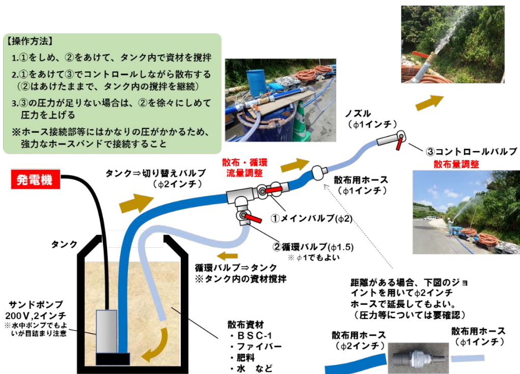
図 2.2-2 水中ポンプを用いた散布機器の構成及び基本的な使用方法
