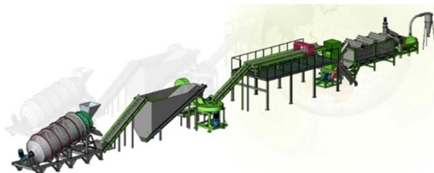
図 11 PET フレーク洗浄・ペレット化ラインの概略図（提供：NCT 化学）
