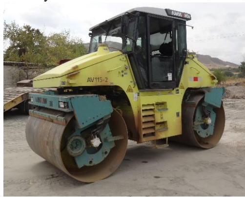
Фото 10-11 Виброкатки VR: AMMANN AU-115-2 (11.6 тонн) (справа)
