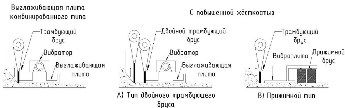
Рисунок 5-1 Пример усиленной стяжки асфальтоукладчика
