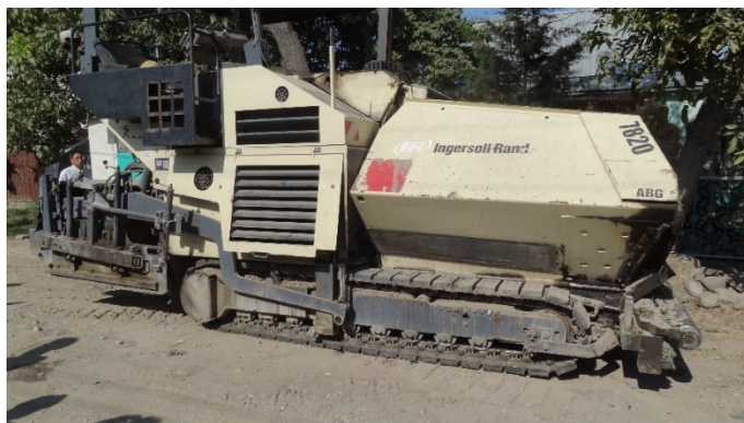
Фото 10-3 Использованный асфальтоукладчик марки ABG Titan 7820 (TV типа)
