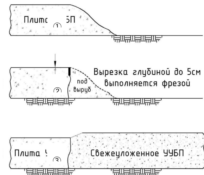
Рисунок 5-5 Процедура строительных работ стыковых швов
