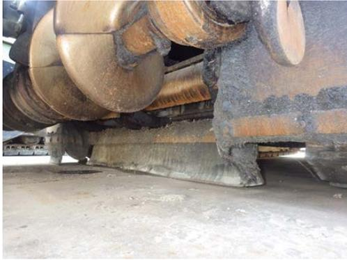
写真 10-4 ゴム製パーティションの取り付け
