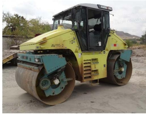
写真 10-11 バイブロローラー VR : AMMAN AU-115-2 (11.6 トン) (右側)
