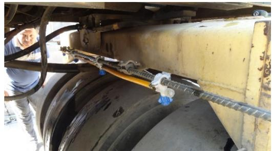
写真 10-12 タイヤローラー空気圧機器
