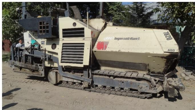
写真 10-3 使用済みアスファルトフィニッシャーABG Titan7820
