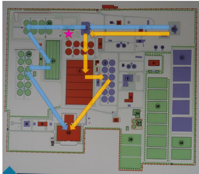
【写真 4-2 : ASA 排水処理場の処理フローと試験機設置場所】
