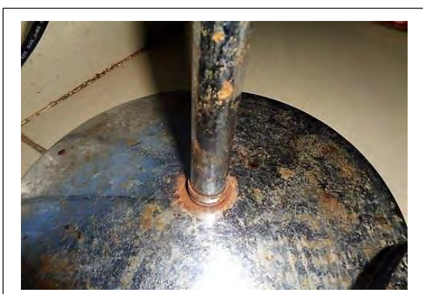
第1期分供与機材 錆が目立ち始めた ゲースネックランプの土台部分
