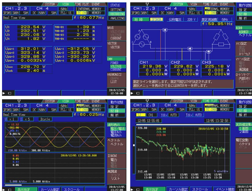
電源波形のリアルタイム観測及び電圧変動の測定結果（一部データ抜粋）
