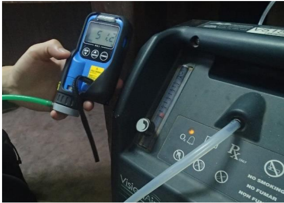
写真 1.6 未整備のため酸素濃度が51%程度
