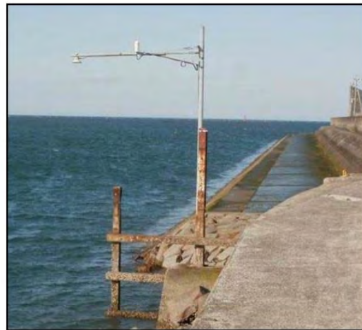
図 7.3.114 超音波式・電波式水位計イメージ
