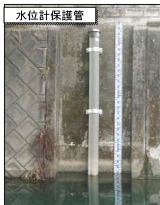
図 7.3.113 水圧式（水晶水圧式）水位計設置例（日本）
