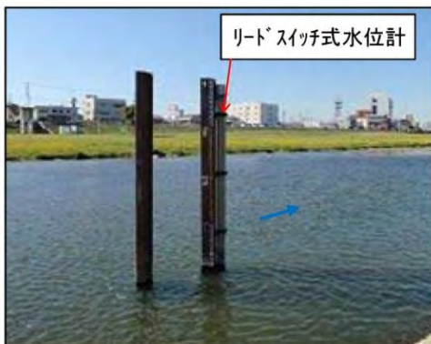
図 7.3.110 フロート式水位計設置例（日本）
