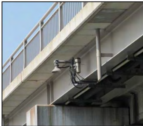
図 7.3.115 超音波式・電波式水位計設置例（日本）
