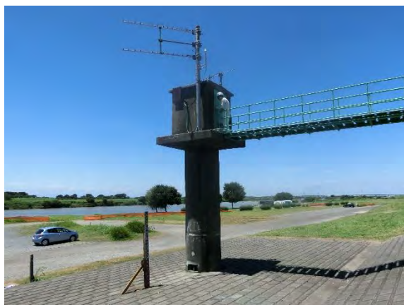
図 7.3.106 フロート式水位計設置例（日本）
