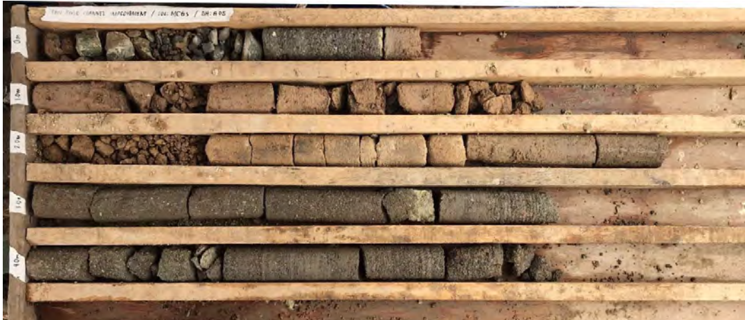
図 5.2.17 （写真）G-05 孔 0-5mコア状況 （赤色部が凝灰岩、灰色部は火山礫凝灰岩）
