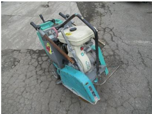
写真5 コンクリートカッター
