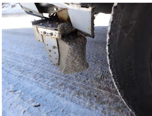
写真：センサーの雪塊付着状況
