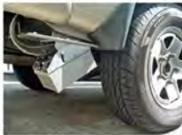
塩分濃度センサー取付例
