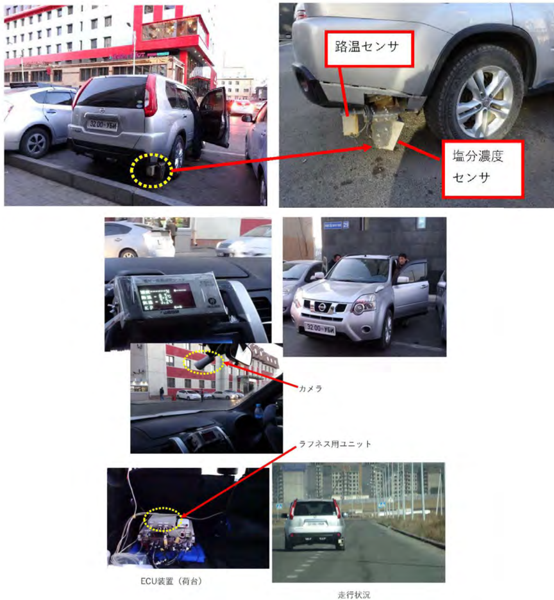
写真：塩分濃度センサーの車載装備状況 出所（山田技研）
