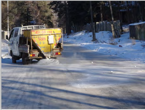
写真：専用車両による凍結防止剤散布
