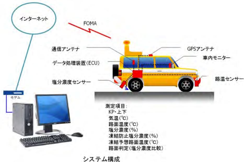
図-8 車載式塩分濃度センサーシステムの概念図
