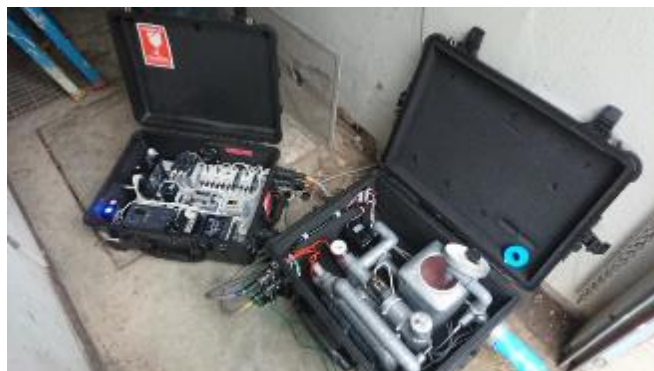
写真 5 TRT 装置（左：計測制御ユニット，右：温水循環ユニット）
