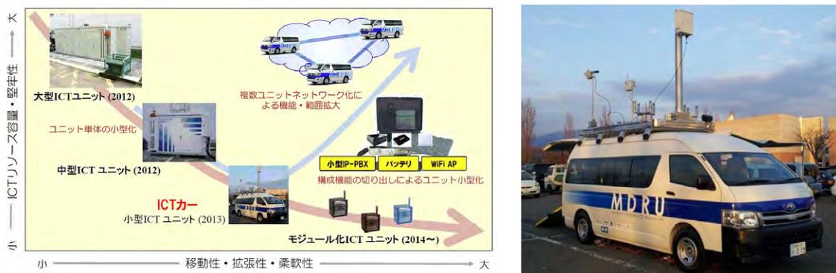
図 6-31 NTT が開発している移動式 ICT ユニットの開発ロードマップと小型 ICT ユニットの搭載した「救急通信車」MDRU ( 出典 : NTT 社 資料 )
