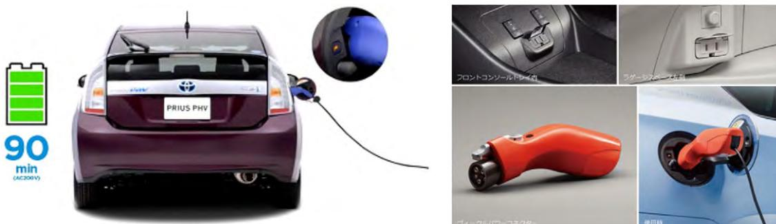
図 6-41 災害時に利用できる 100V 電源出力が追加されたプリウス PHV(ZVW35 系)
