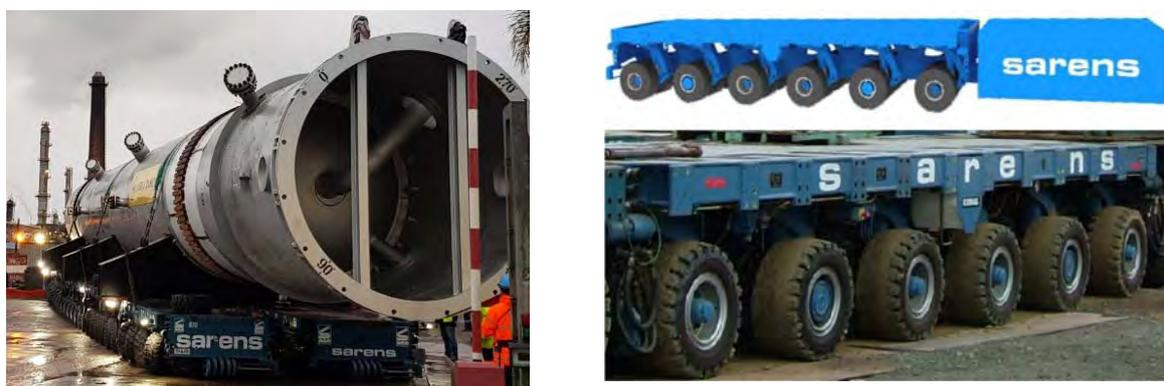
図 3-10 低床多軸トレーラの一例
