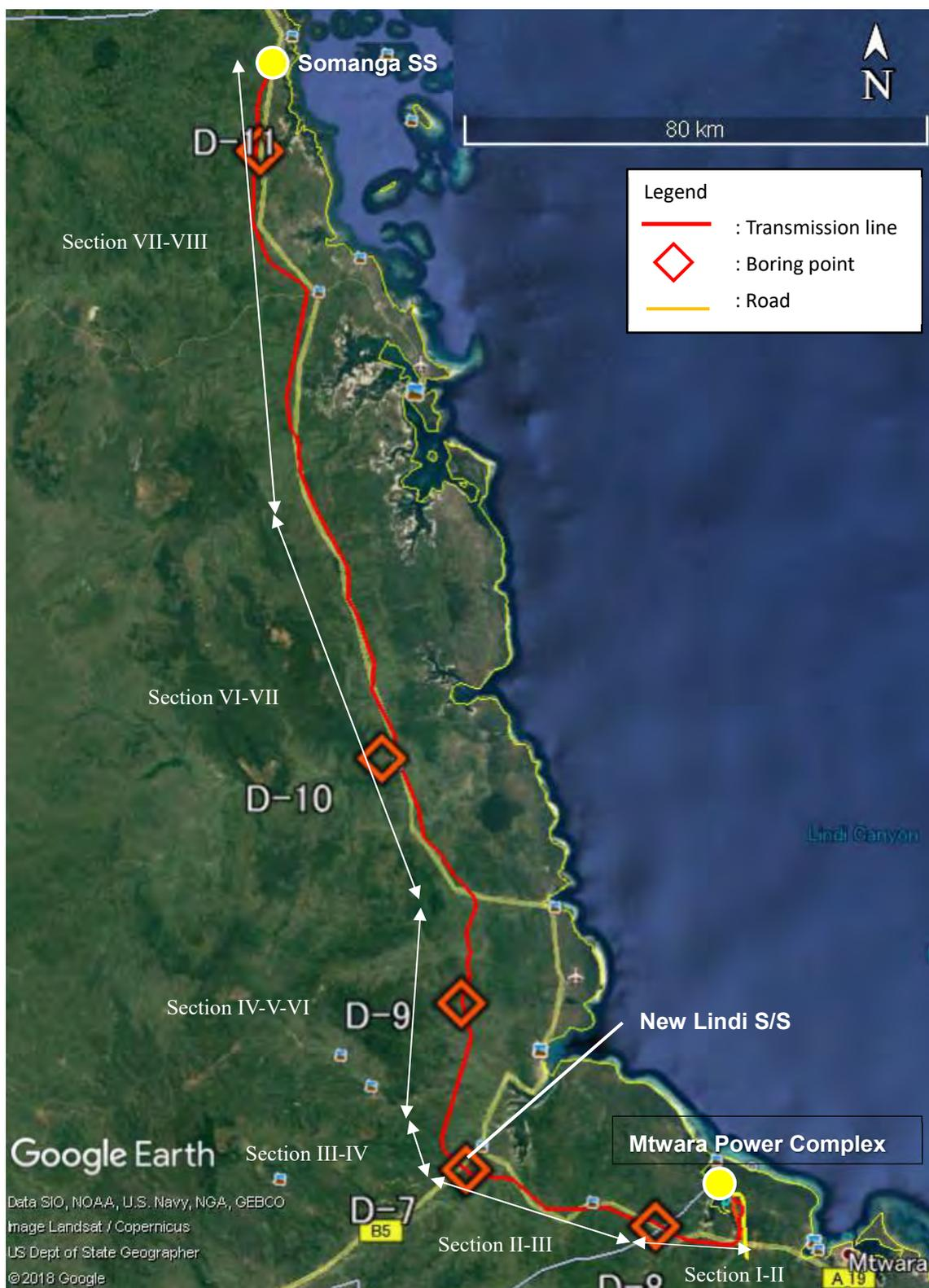
図 7-9 送電線及び変電所の地質調査地点
