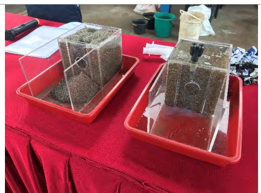
簡易注入試験モデル 左：注入なし 右：注入あり
