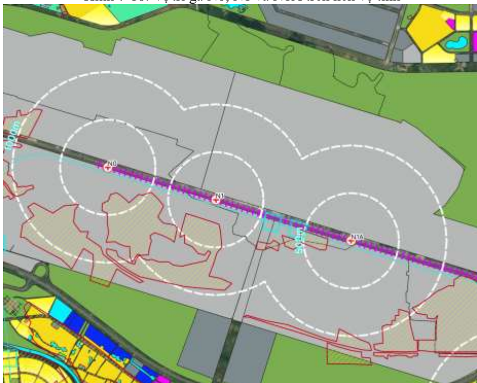
Hình 7-11. Vị trí ga N0, N1 và N1A theo quy hoạch sân bay Nội Bài
