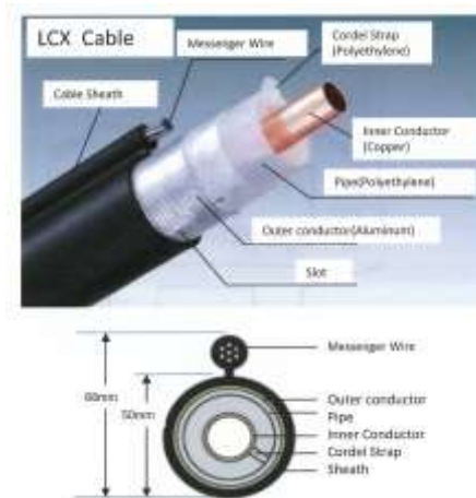
Kết cấu cáp LCX trong khu đoạn hầm.
