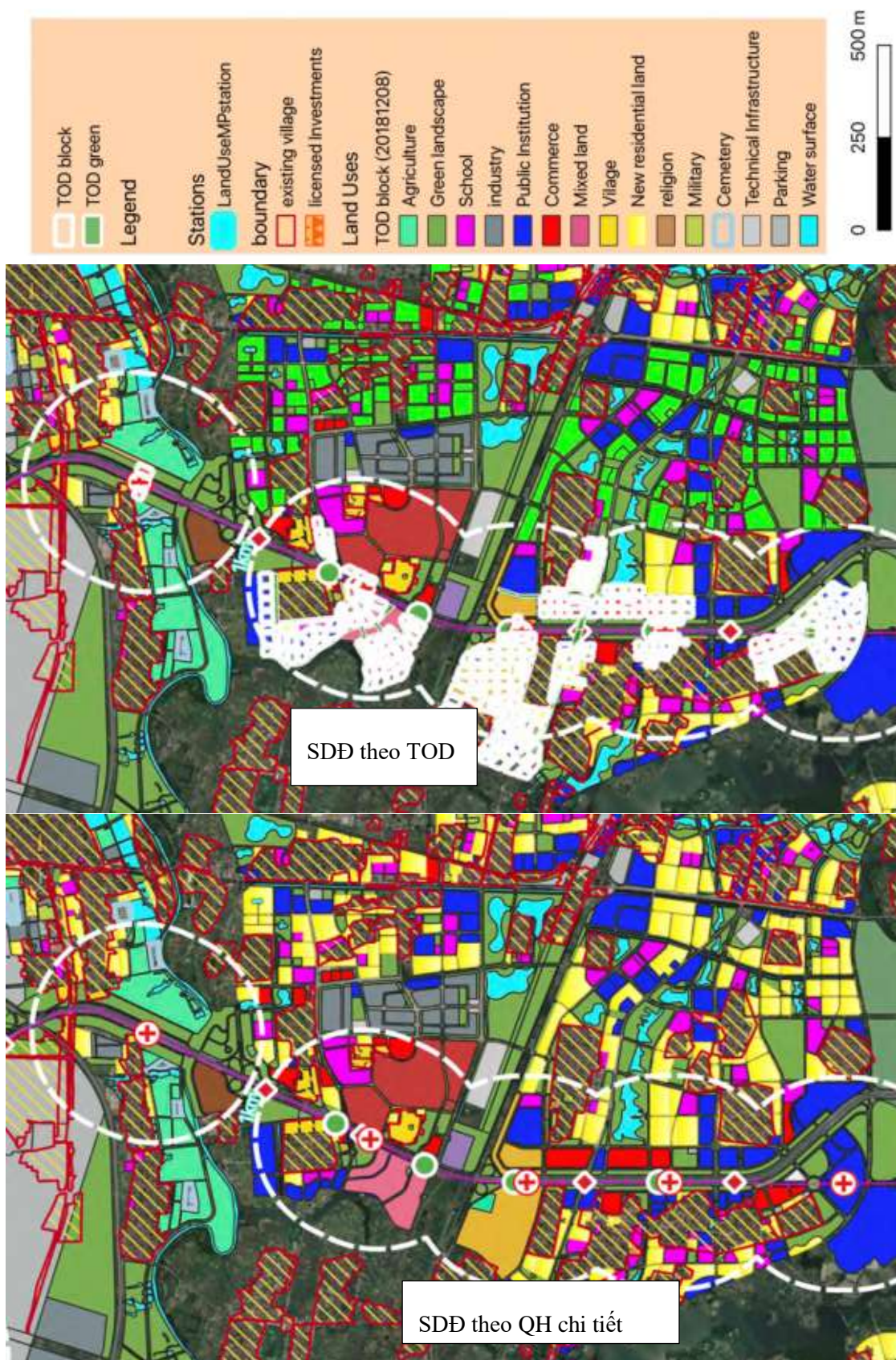
Hình 13-21. Chức năng sử dụng đất (SDD) theo quy hoạch chi tiết và theo phát triển TOD
