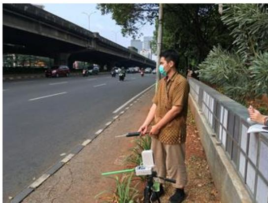
図 4. 4. 7. その他のパラメータの測定 (左 : PM2.5 モニター、右 : S02 サンプラー)
