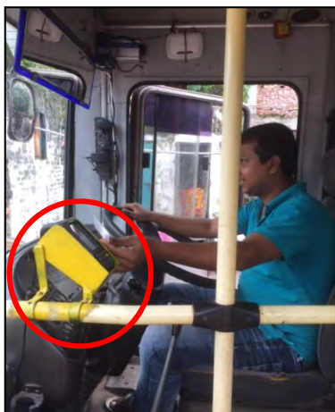
運転席脇に固定された携帯型端末 (R/W) 機
