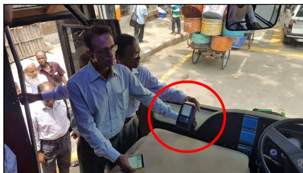
運転席脇に固定された携帯型端末（R/W）機
