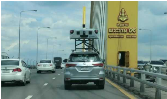
図 4 EXAT 路線の3次元点群計測、GIS データベース構築
