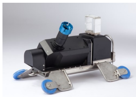
スーパーメガモグ (対応する下水管の口径：単位=mm Φ350・Φ400・Φ450・Φ500・Φ600)
