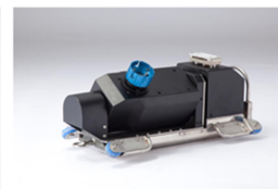
スーパーメガモグ (対応する下水管の口径:単位=mm) ・φ350・φ400・φ450・φ500・φ600
