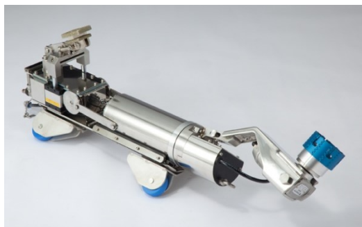
スーパーミニモグ (対応する下水管の口径：単位=mm Φ150・Φ200・Φ250・Φ300)
