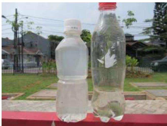
図 3.14 処理前後の水の状況 (左 : 流入水、右 : 処理水)
