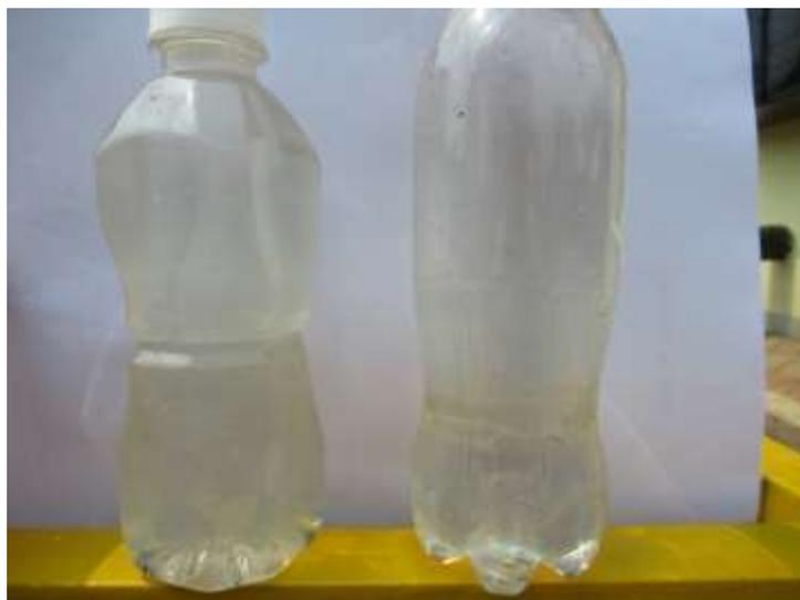
図 3.17 活性汚泥の流出状況 (左：流入水、右：処理水 (活性汚泥が浮遊))
