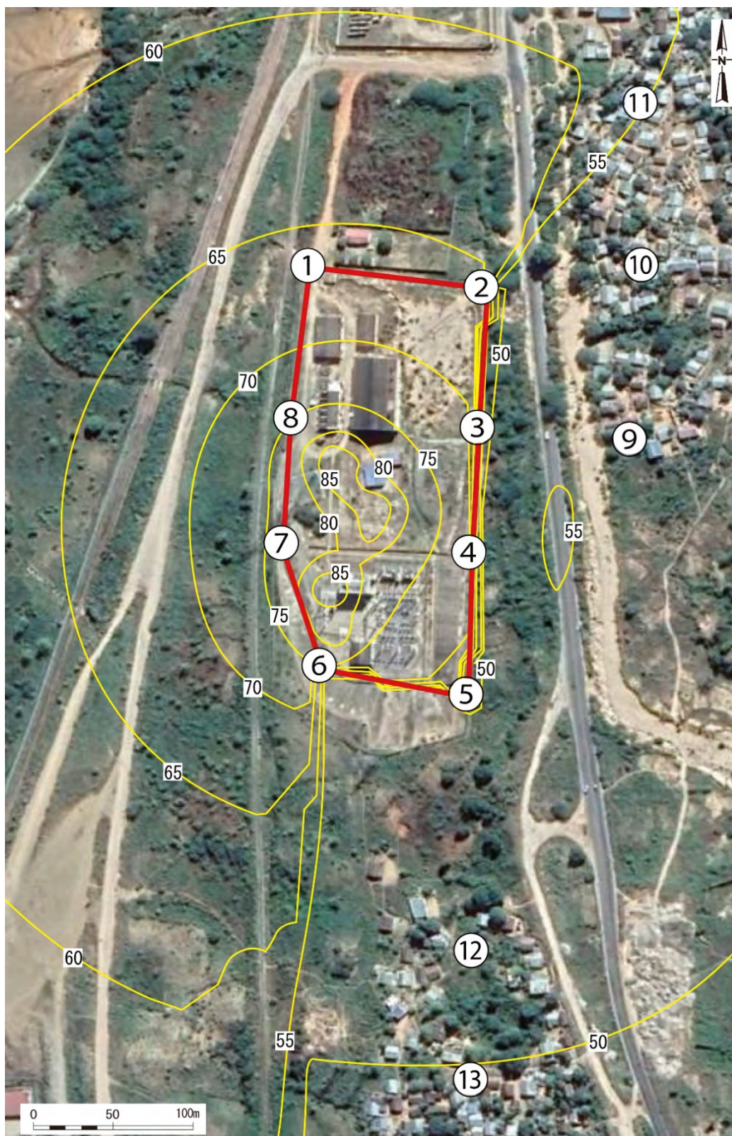
図 4-24 建設機械の稼働に伴う騒音レベルの分布予測図 (仮設フェンスを設置した場合) (単位: dBA)
