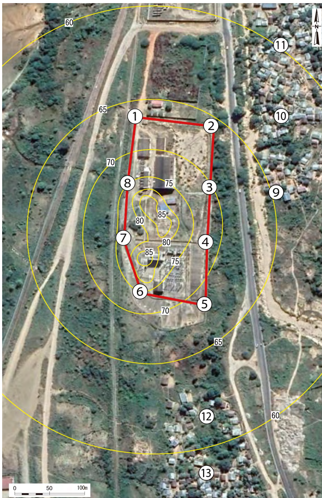
図 4-23 建設機械の稼働に伴う騒音レベルの分布予測図 (仮設フェンスを設置しない場合) (単位: dBA)
