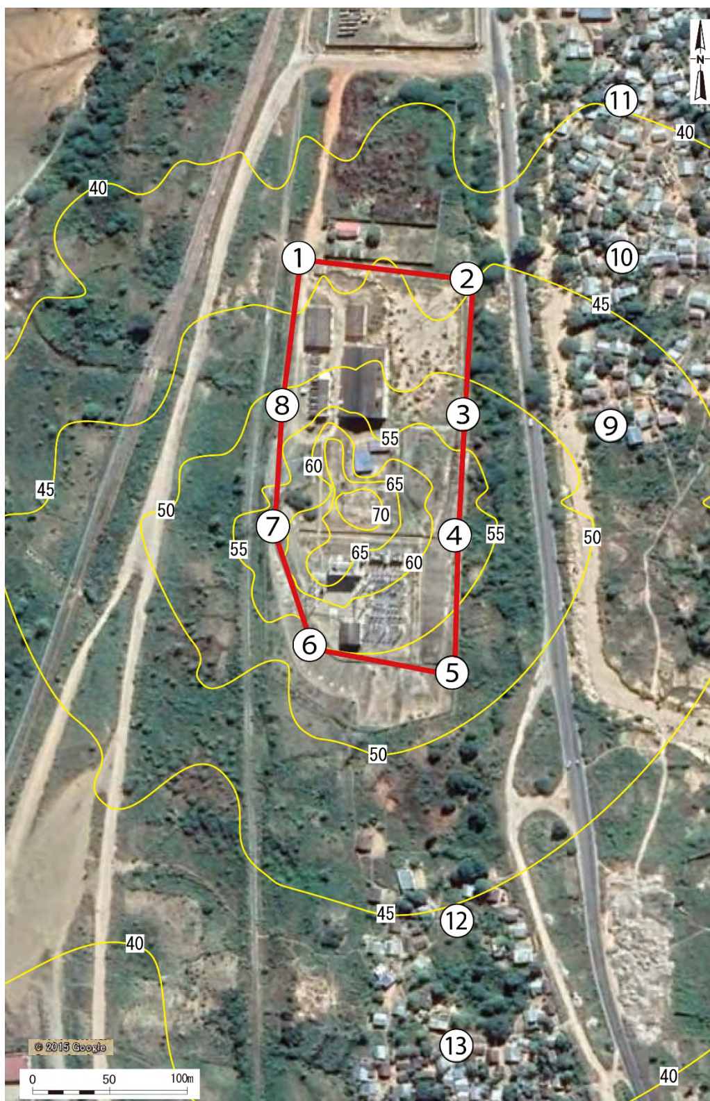
図 4-33 発電所の運転に伴う騒音レベルの分布予測図 (単位: dBA)
