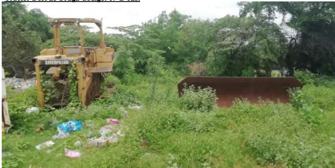
Tractor D7H de Oruga Código: 07-B-031: Recalentamiento de sistema hidráulico, de acuerdo a NIMAC la bomba hidráulica esta descontinuada por lo que no pueden ofertar.ca
