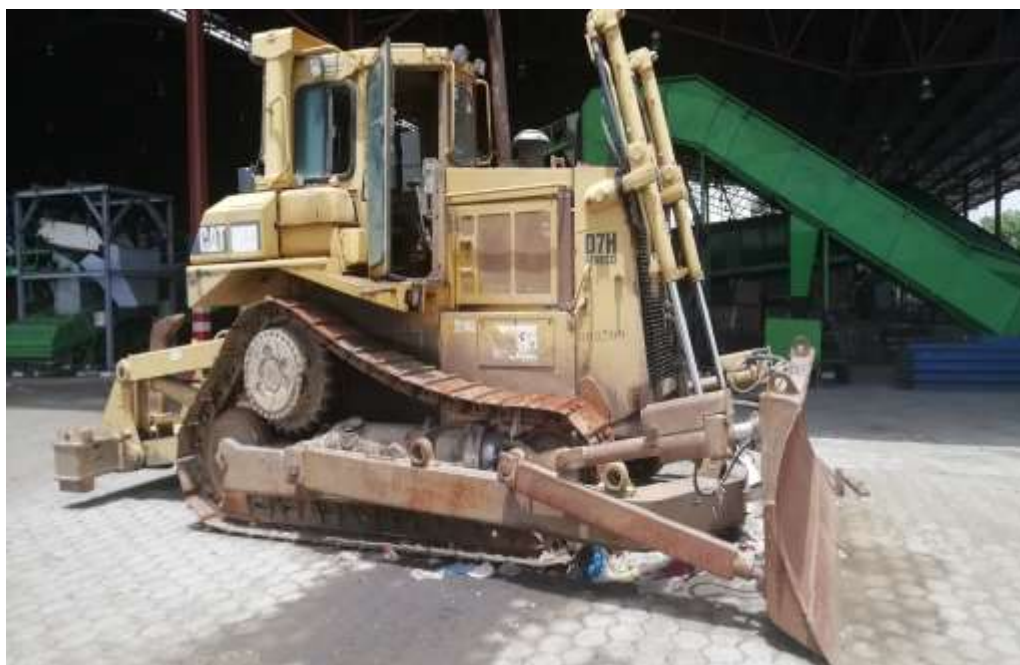
Tractor D7H de Oruga Código: 07-B-031: Recalentamiento de sistema hidráulico, de acuerdo a NIMAC la bomba hidráulica esta descontinuada por lo que no pueden ofertar.ca
