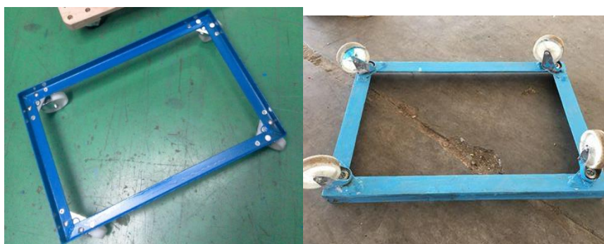
(写真 136: 日本で製作したアングルフレーム型台車のサンプル (左) とインドで最初に現地製造した台車 (右)。キャスターは日本から持ち込んだ)
