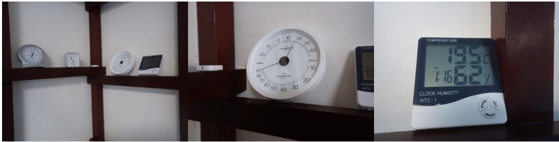
(写真 135: 1か所に集められた温湿度計 (左)、センサーの様子、エンペックス社のアナログ式温湿度計(中央)、HTC-1 Digital のもの(右))
