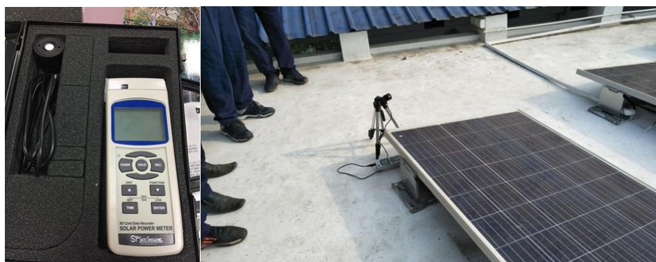
(写真 134 : 日射量計と三脚にセンサーを設置し、計測する様子)
