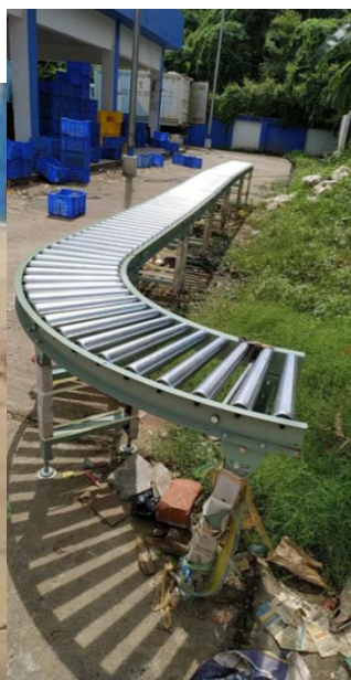
(写真 139 : クレート洗浄に用いているローラーコンベア (左)、高圧洗浄機での洗浄の様子 (右))
