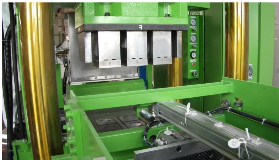
図7 （株）GOTOで製造が完了したプレス機の稼働試験の様子
