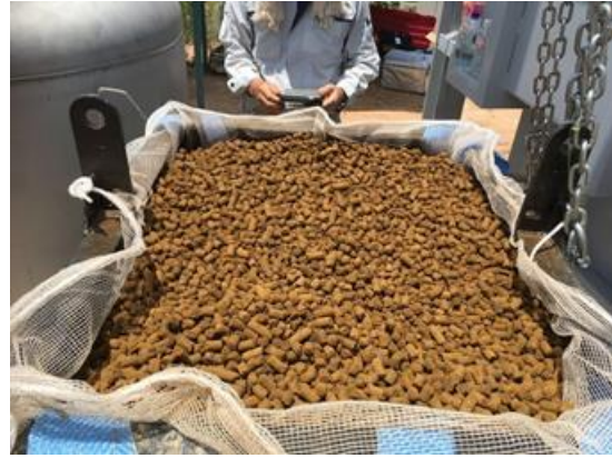
脱色脱臭槽に詰め込まれた阿蘇リモナイト
