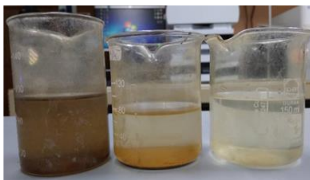
流入水 中間水 処理水 カラム実験による処理前後の様子
