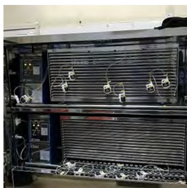
2018年8月24日 機材内部に温度センサーを取り付けバリデーション
