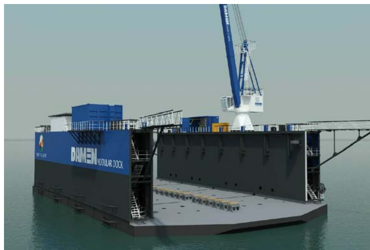
図 2.2-8 フローティングドック全体像（DAMEN 社カタログより転載）
