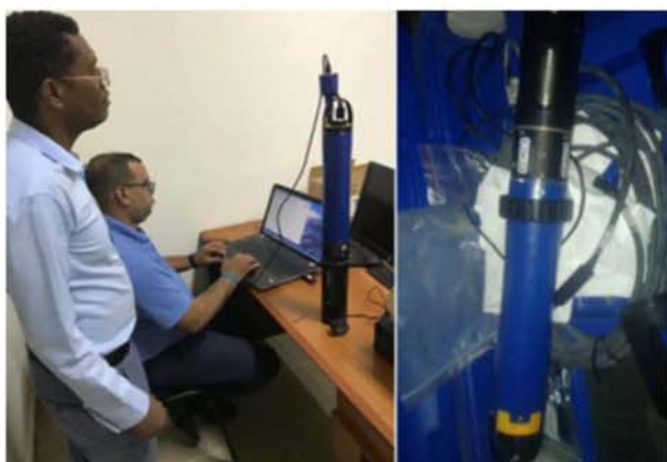
流況・水質観測(キャリブレーション)実施状況:タジュラ港
