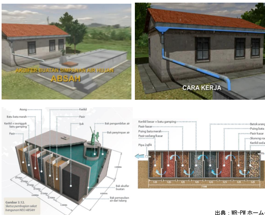
図 3-3 ABSAH プロジェクトで計画されているコンクリート製ろ過貯留施設
