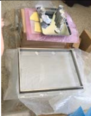
⑨ ステンレスバット・コメ試料水分計測用秤量缶 (上)、コメ試料作成用水分調節容器 (下)
