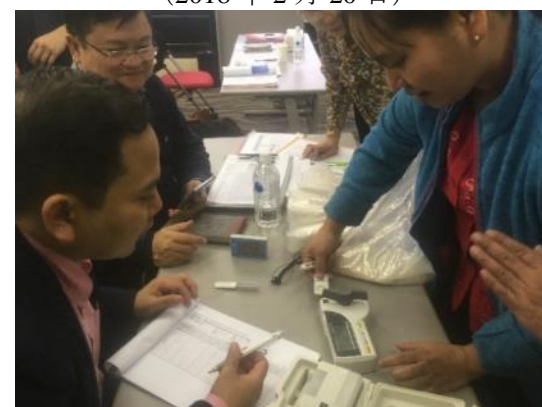
比較参照基準粳・コメ試料を用いた 水分計精度検定研修 (2018年2月22日)
