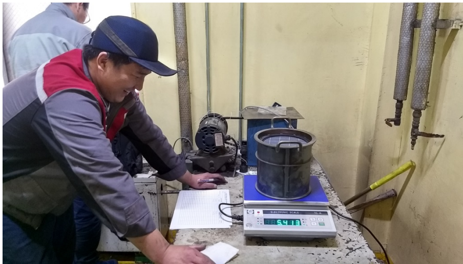
図 1 フィルタ秤量の様子（第 1 バス DPF 再生室）
