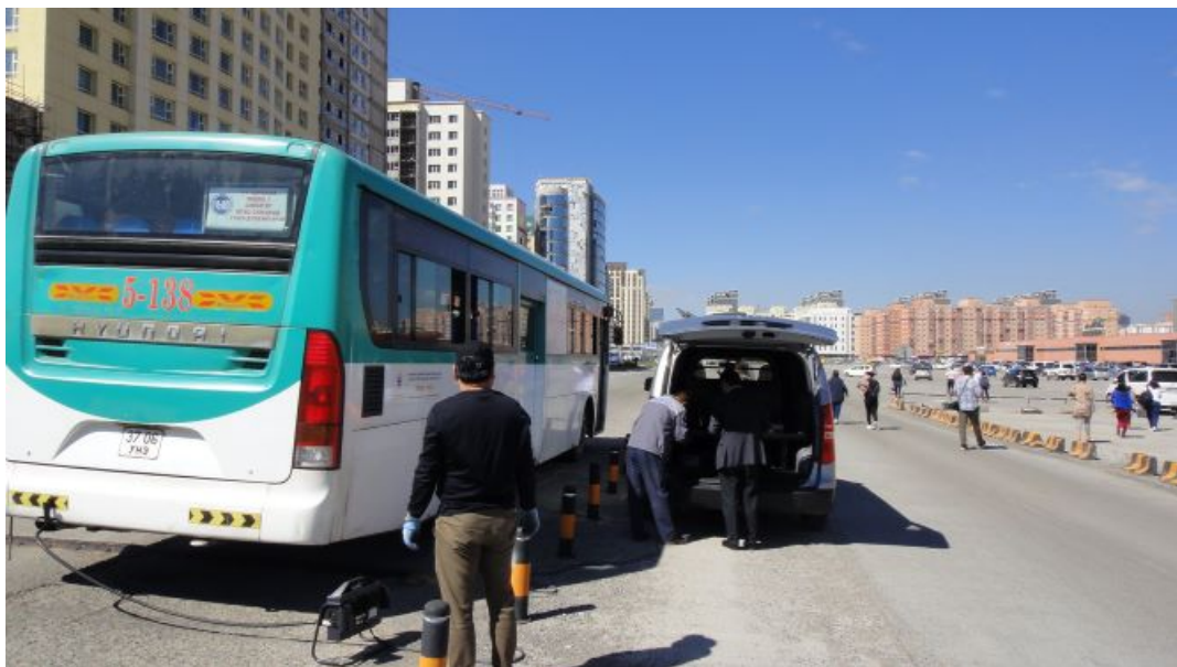
図 1 路線バスの PM 排ガス測定状況（ダウンジングラボ）
