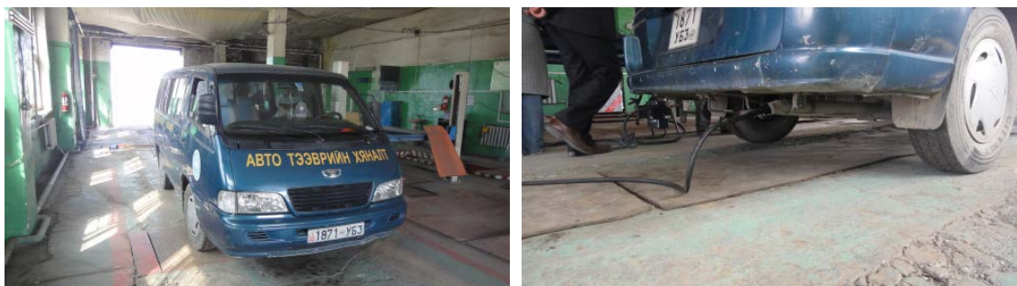
図 5 試験車両外観及びプローブ挿入状況
