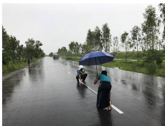
図 1-5 マウビン～ピャーポンハイウェイの区画線規格を測量する JICA 調査団
