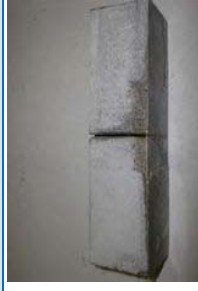
写真：JIS規定 ひび割れ接着試験体
