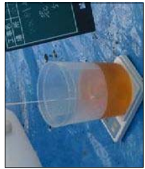
樹脂、硬化剤の計量
