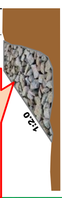
Вариант-2: Каменная наброска (Укрепление валуном/гравийным наполнением)
