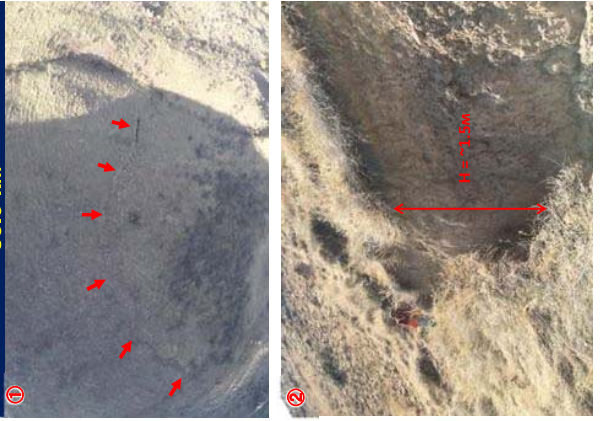
Равнинный, обрывистый и открытый трещинами, небольшие трещины склона старого маяковского доломитов. Она может быть реактивирована в будущем.
