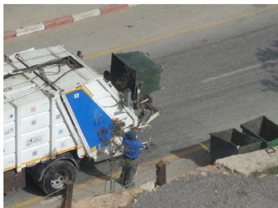
コンパクターによるごみ容器（コンテナ）での収集作業。市街地等を巡回して廃棄物を収集している。
