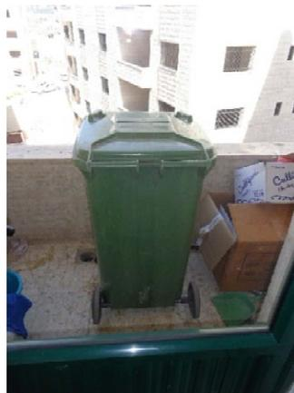
一部個別収集にて利用されている小型プラスチックごみ容器（主に0.24m³コンテナ）。家庭内の玄関先等に設置し、住民はごみが溜まると収集車両の巡回時間帯までに道路脇に移動させる。
