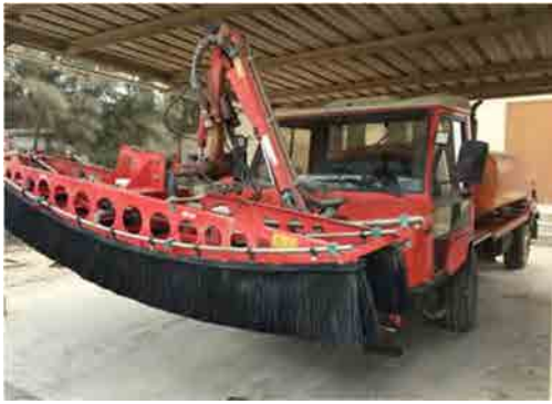
写真 1: 太陽熱集熱器の専用清掃車両
