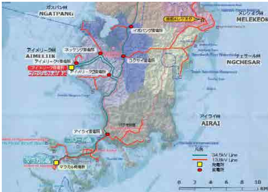
図1 コロール島及びバベルダオブ島（南半分）の送配電系統
