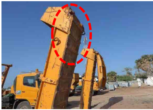
レールのパーツが欠損しているトレーラー サイドバーが破損している 10 m 3 コンテナ
