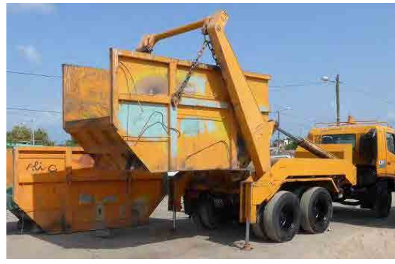
レールのパーツが欠損しているトレーラー サイドバーが破損している 10 m 3 コンテナ
