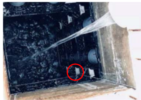
2017年12月28日タンク内注水と漏水試験用水位センサー設置(赤丸、2018年1月11日～17日の水位変化を計測)
