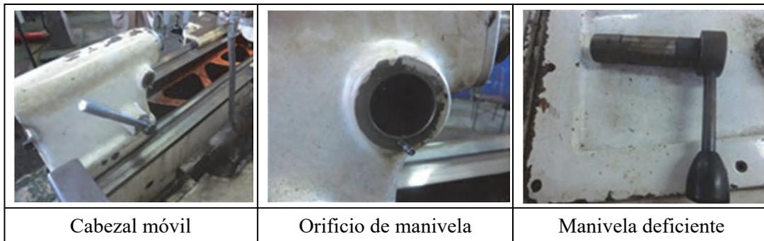
Fotos 3-6: Deficiencia del cabezal móvil
