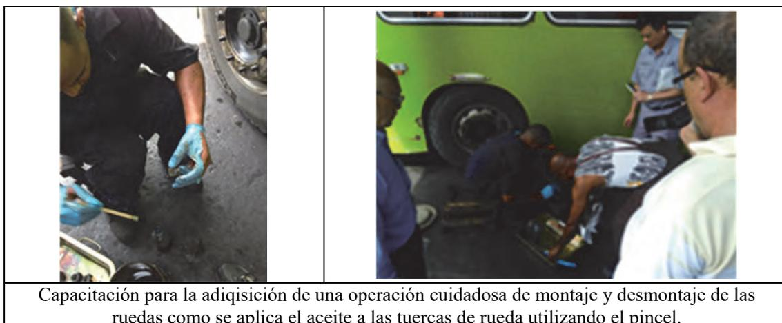
Capacitación para la adquisición de una operación cuidadosa de montaje y desmontaje de las ruedas como se aplica el aceite a las tuercas de rueda utilizando el pincel.
