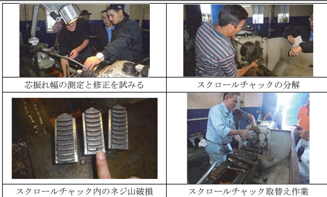
写真 3-5 : スクロールチャックの取替え
