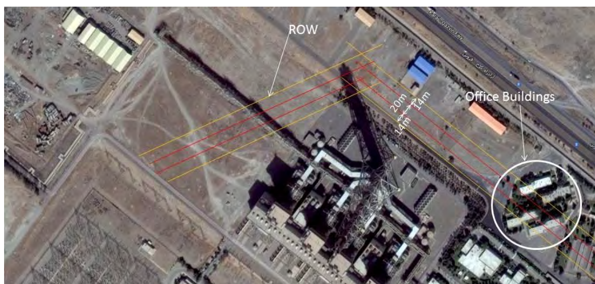
図 5-104 400kV 架空送電線の ROW
