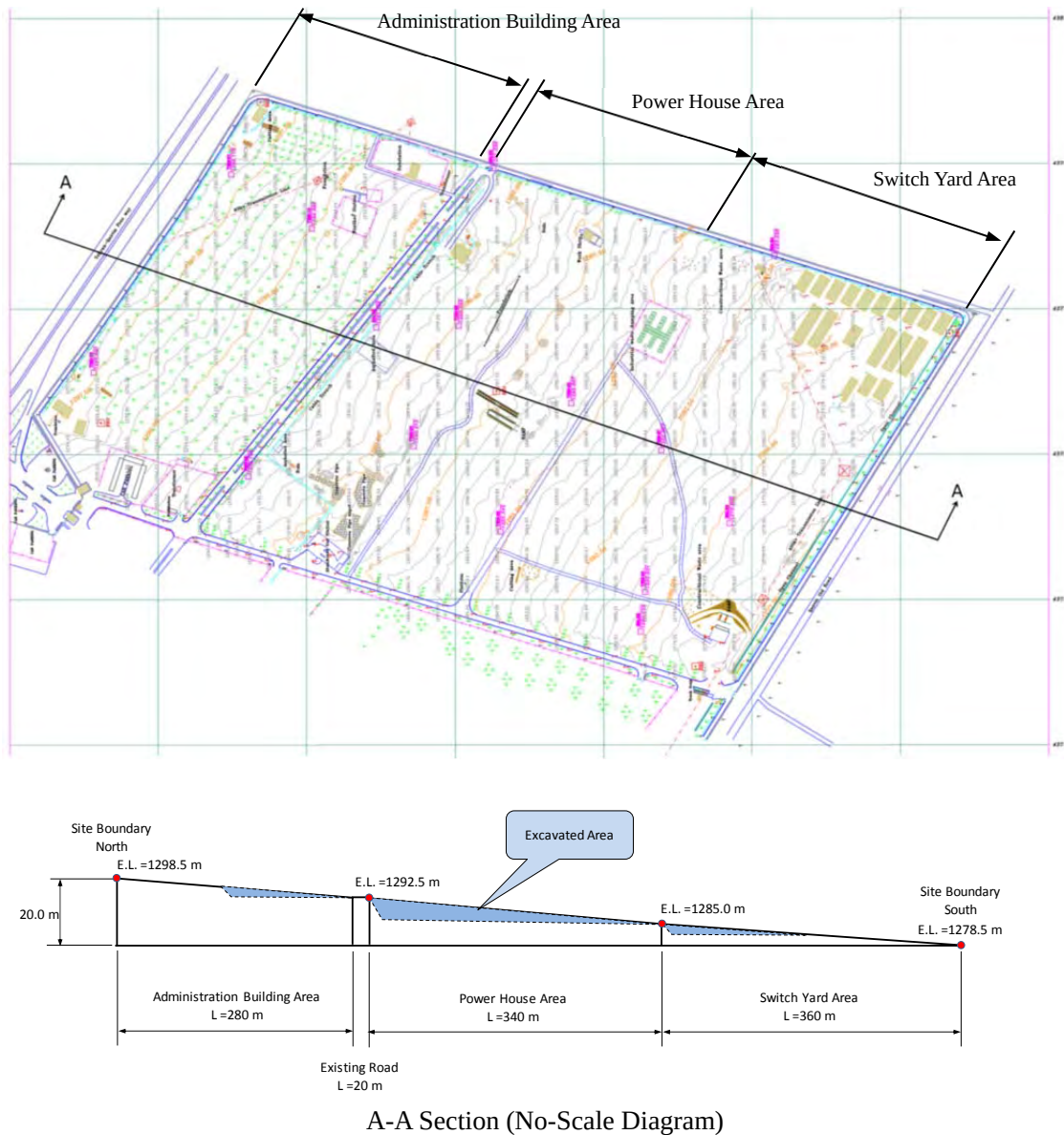
図 3-9 測量により作成した地形図
