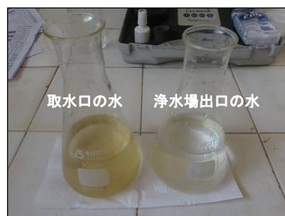
コンセプション浄水場： 取水口の水と浄水場出口の水
