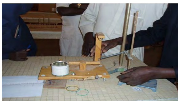
プロジェクトが作成した地学実習教材（地震計）
