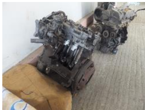
自作のエンジンカットモデル
