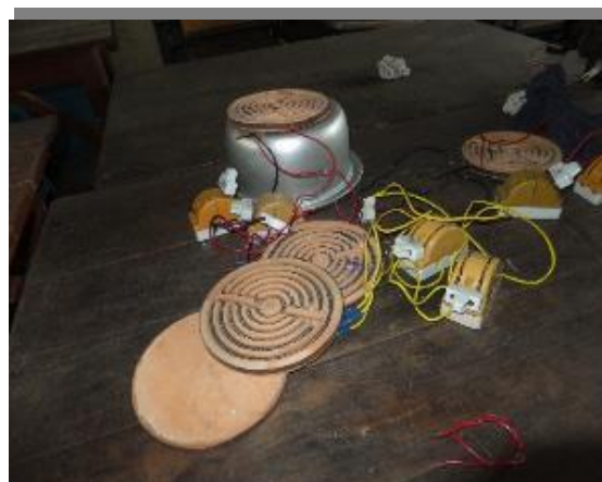
電熱器の構造
