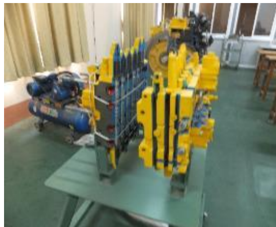
カットモデル (油圧コントロールバルブ)
