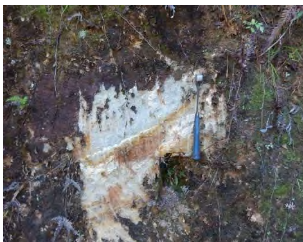
図 7-19 サージタンク下流斜面での露頭（強風化の片麻岩）
