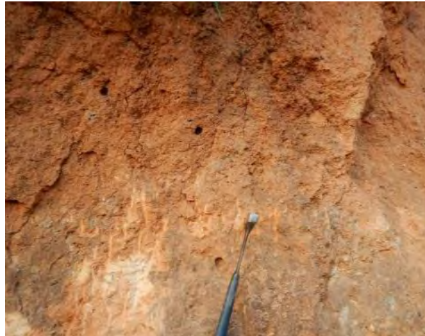
図 7-20 導水トンネル取水口周辺の表土（赤褐色を呈する粘土質砂質土）
