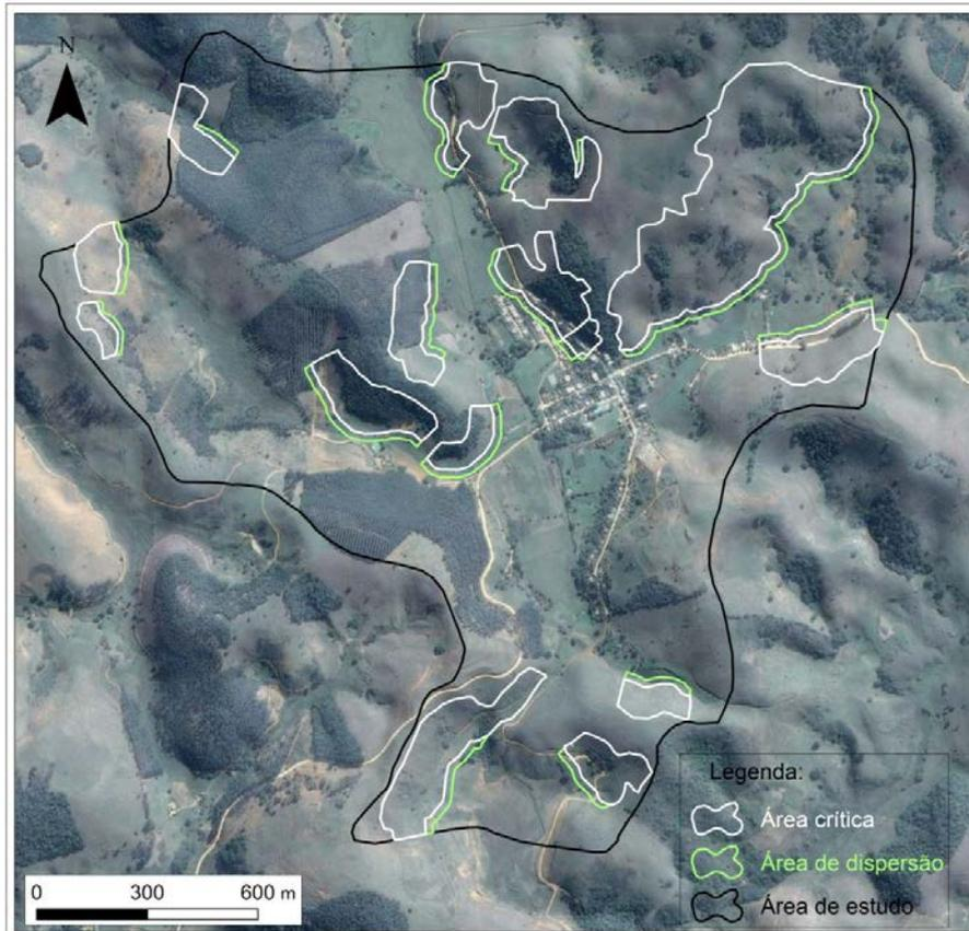
**Figura 2.19: Limites das áreas crítica e de dispersão para o processo de deslizamento planar.**
