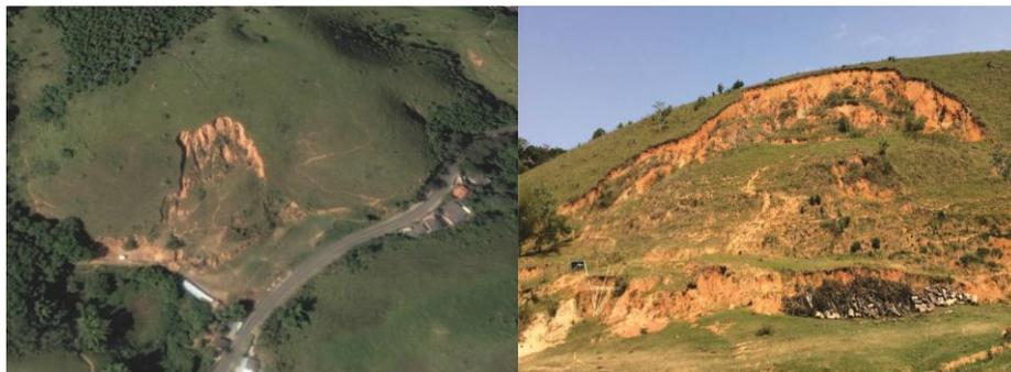
Figura 1.4 A: Imagem de satélite que exhibe deslizamento rotacional em planta em Passa Três, Rio Claro (RJ), com movimentação de grande volume de material. Imagem obtida pelo *Google Earth*.
