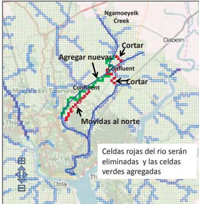
Para modificar el canal del río, por lo menos 5 archivos deberán de ser cargados de manera **manual** (DEM, DIR, ancho de río , profundidad de río , altura de bancos)
