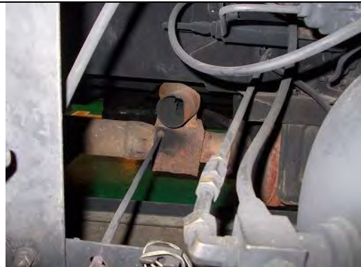
排水コック、ブレーキ装置の凍結防止
