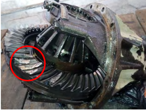
デファレンシャル装置リングギヤの破損
