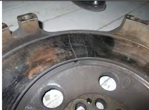
フライホイールの亀裂
