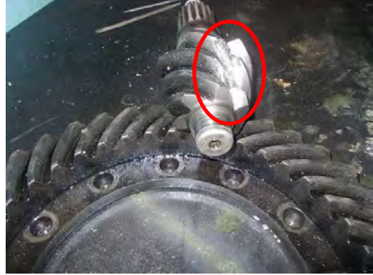
ドライブピニオンギヤの破損
